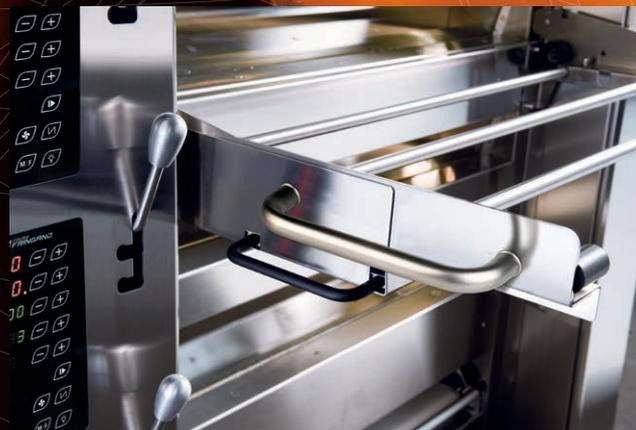
L'utilisation du tapis enfourneur est facilitée par l'élévateur parfaitement intégré à la façade du four.
